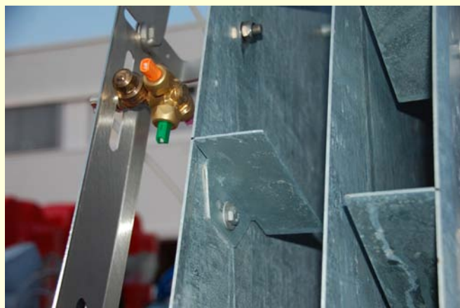
Vienkārši regulējami miglotāju deflektori jeb novirzītāji un attiecīgi sprauslas, kuras var mainīt, mainot arī sprauslu novietojuma leņķi
