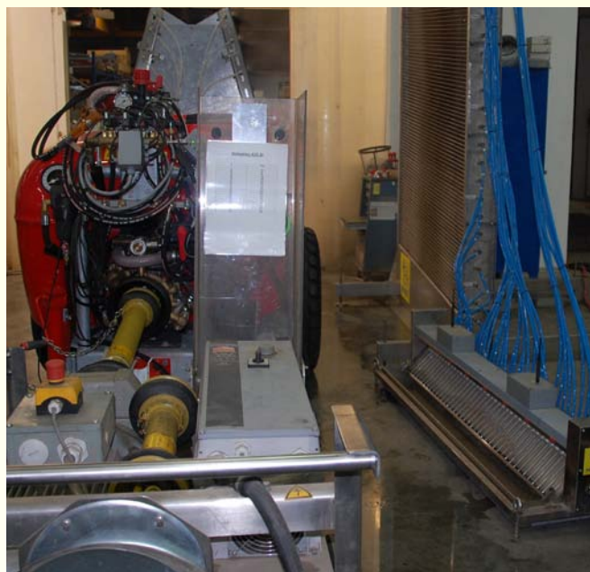
Miglotājs ražotnē pieslēgts pie viena no stendiem, kas analizē izsmidzinātā šķidruma sadalījumu visā noklājuma augstumā. Tas tiek darbināts noteiktu laiku, savācot detalizēti testa laikā izmantoto ūdeni speciālā veidotā rievsienu, kas ir noteiktā attālumā no agregāta, imitējot koku vainagu, jo svarīgi, lai smidzinājuma pilieni paliktu koku vainaga iekšpusē
