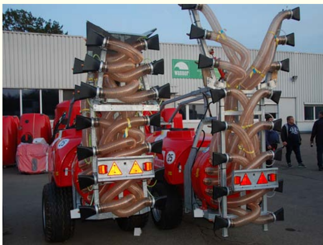
Divi dažādi miglotāji ar specifiskiem gaisa plūsmu un smidzinājuma novirzītājiem
