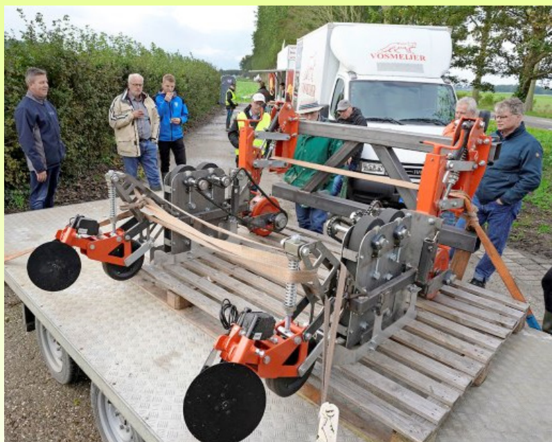
Ar šo mašīnu ir iespējams ļoti precīzi iesēt burkānus uz lentām. Foto: Ruud Ploeg
