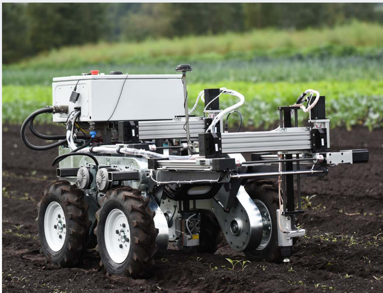
Projekta RONIN ietvaros izstrādātais precīzās ravēšanas robots
