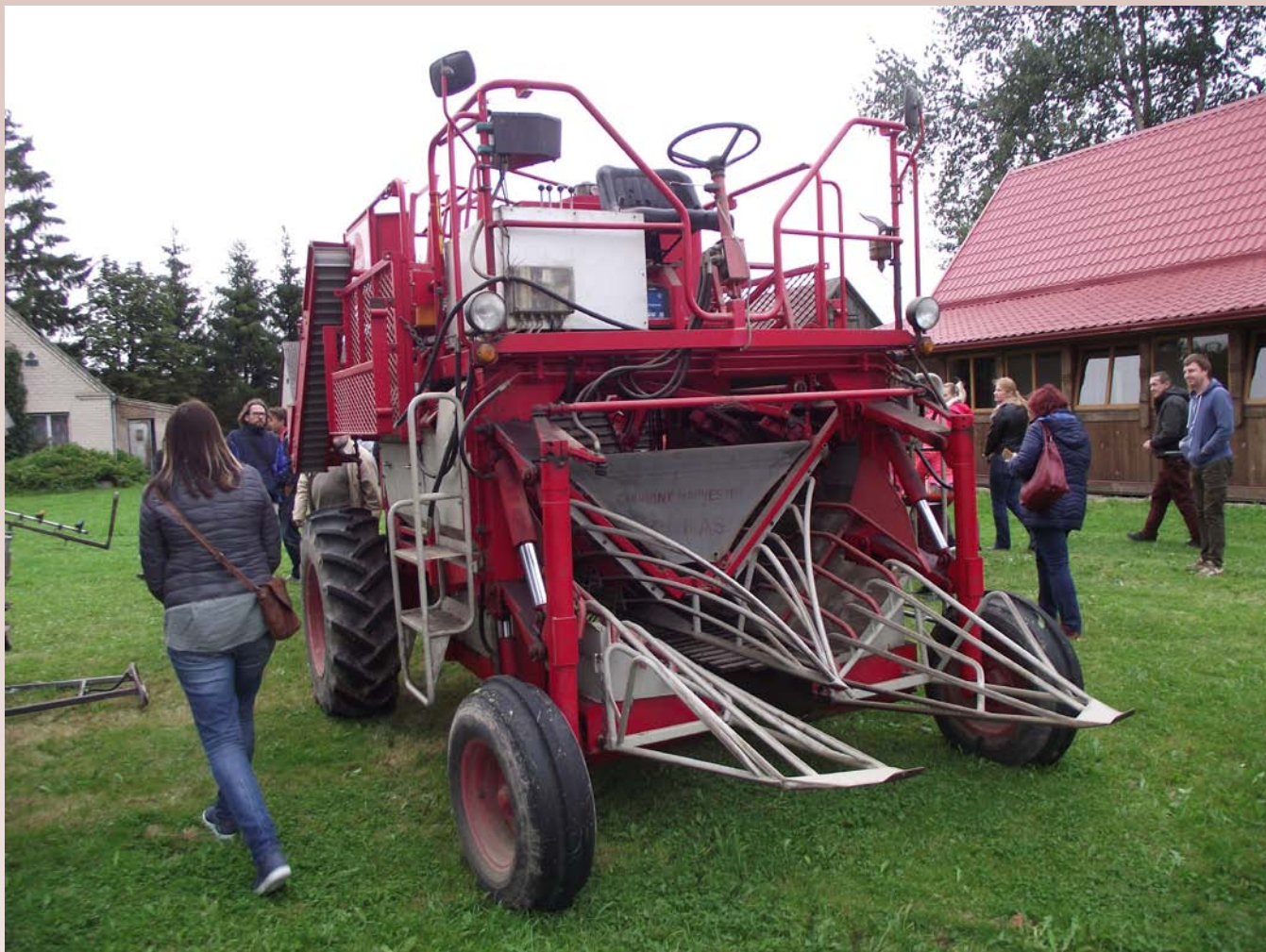
Visās lielākajās lietuviešu ogu audzētāju saimniecībās ir iegādāti ogu vākšanas kombaini. Pilnas rindas jeb abpusējais ogu vākšanas kombains JOONAS A. Jasinevičius saimniecībā.
