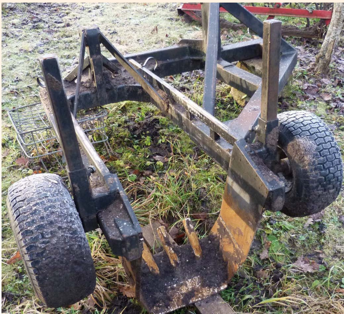
Stādu rakšanas arkls- nobīdīts no traktora garenass, lai ir vieta strādniekam izņemt izceltos stādus
