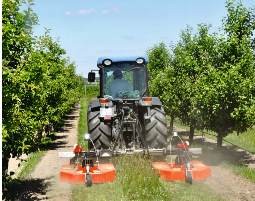
Mulčēšanas iekārta darbībā (modelis "Humus OMB®"). Atbilstoša zemeszemes kopšana (apdobju un rindstarpu kopšana) un ziedošo augu joslās iekārtošana ir kritiski svarīga, un tā jārealizē, ievērojot konkrētās vietas apstākļus.
