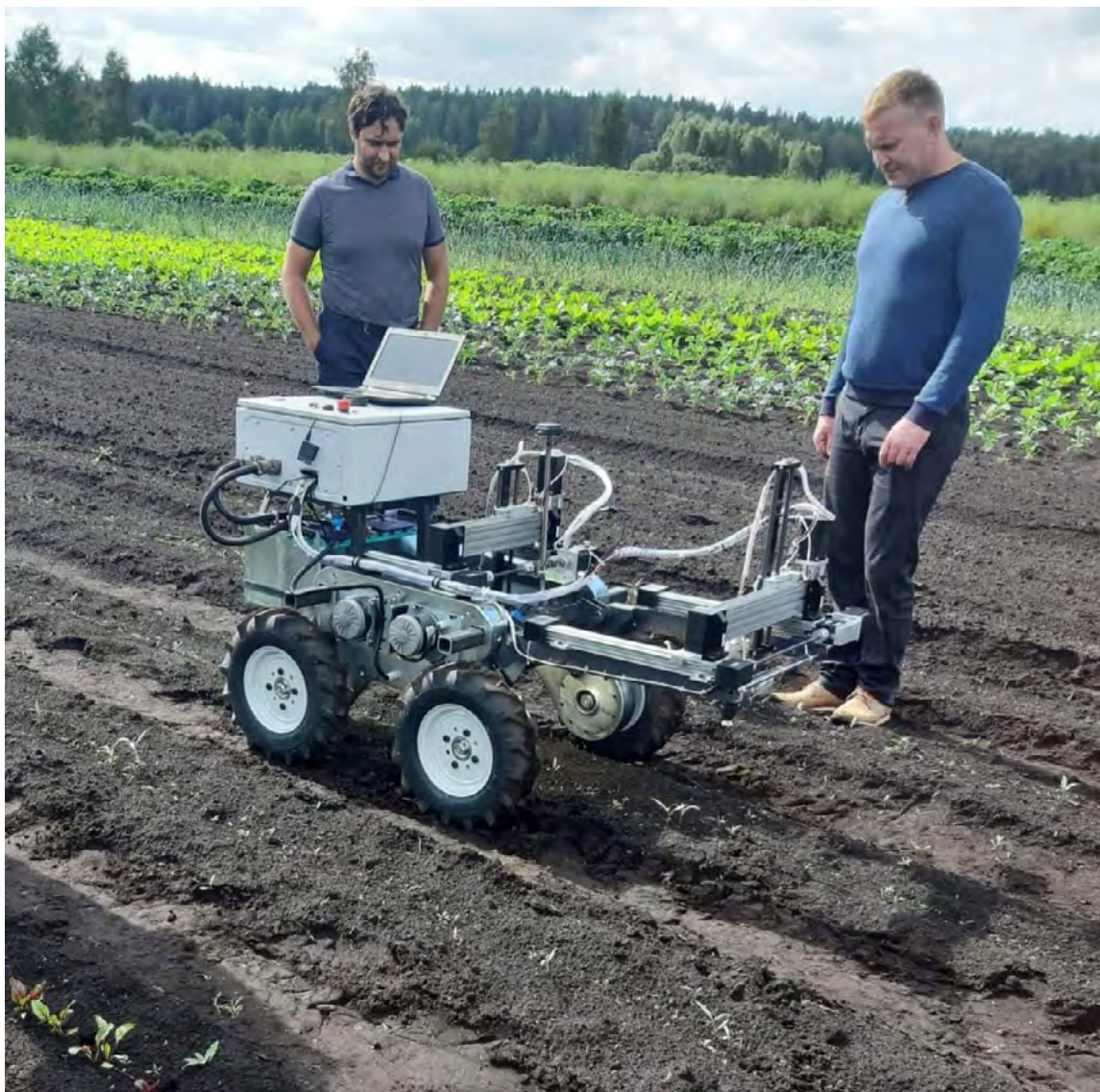
FOTO: Nezāļu robota sākotnējais prototips demonstrēts z/s Atvases
